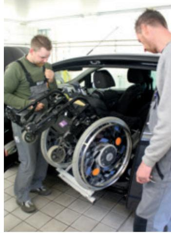
**Knifflig: Manuel Fingas (links) und Sören Heger gelingt die gleichzeitige Anpassung an zwei vollkommen unterschiedliche Rollstuhlmodelle**
