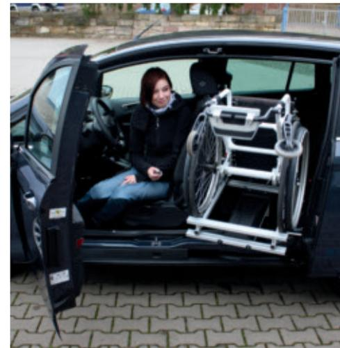
**Durchgehend geöffnet:** Durch die fehlende B-Säule entsteht ein 1,50 Meter breiter Einstieg
