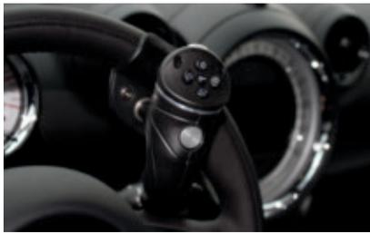
**Ungewöhnlich:** Multifunktionsdrehknopf rechts am Lenkrad und Gasgriff links montiert
